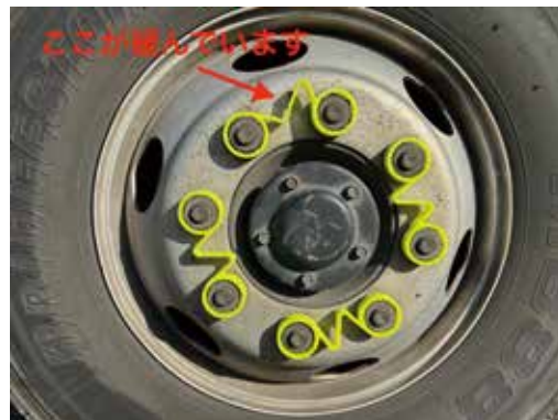
ナットが1ヶ所緩んだ状態 (装着例：コンテナ用トレーラーヘッド フロント 8穴 41mm) *写真はイメージです。実際にナットが緩んだ状態とは異なります。
