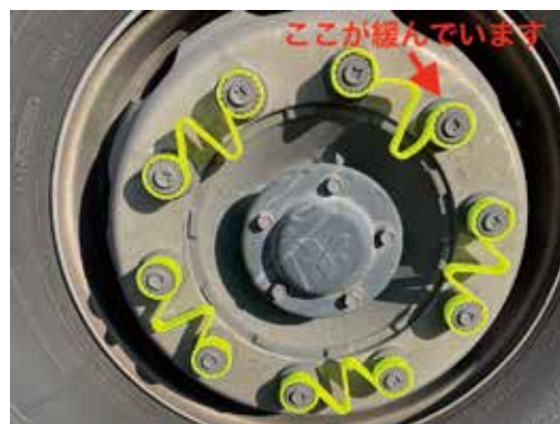
ナットが1ヶ所緩んだ状態 (装着例：コンテナ用トレーラーヘッド フロント 10穴 33mm) *写真はイメージです。実際にナットが緩んだ状態とは異なります。
