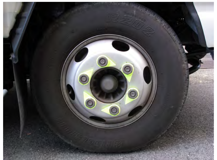
装着例：3tトラック フロント 6穴 41mm
