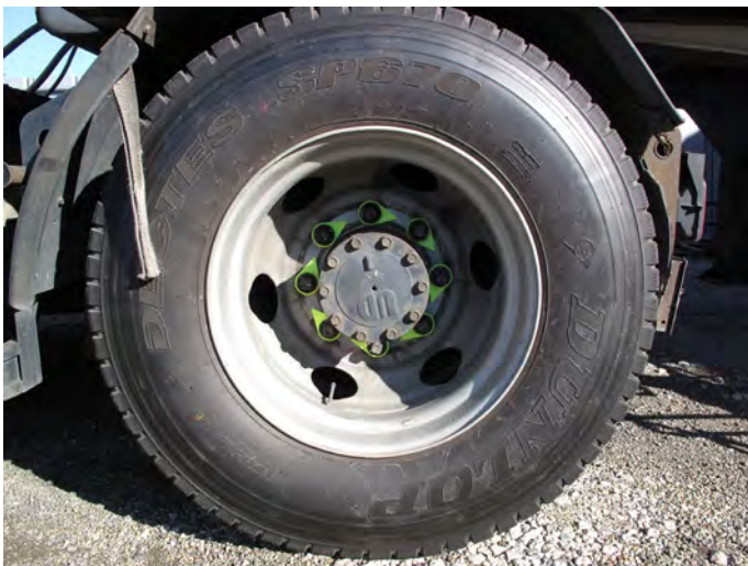
装着例：コンテナ用トレーラーヘッド リア 8穴 41mm
